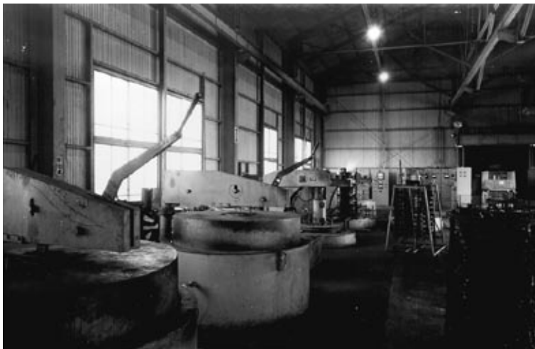
小楠熱処理工業に導入したガス浸炭焼入れ炉。この頃、有害なシアン系の廃液を出す液体浸炭からガス浸炭に切り替えた。
