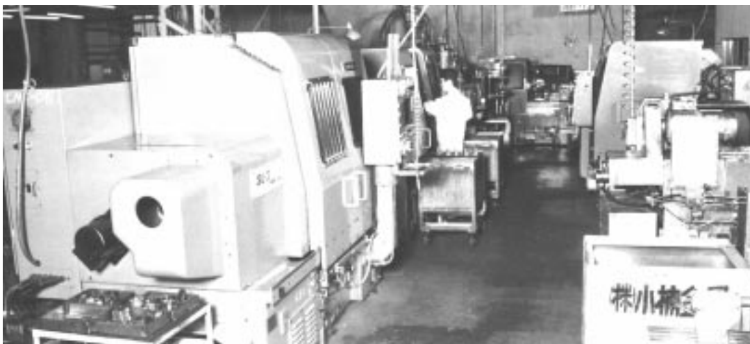
NC旋盤の導入を機に、生産性が大幅に向上した。 写真はNC旋盤によるクランクシャフトの切削加工ライン。
