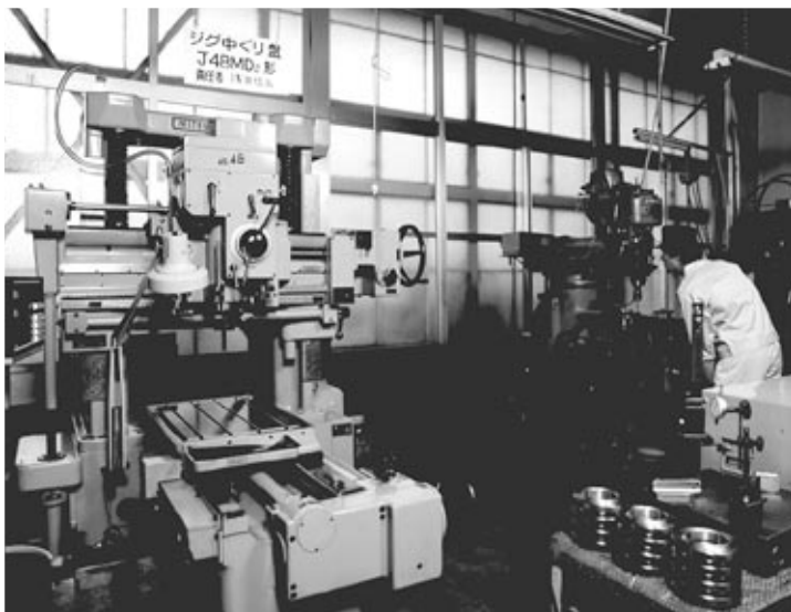
三井治具ポラーの導入で、内作治具の加工精度が向上した。
