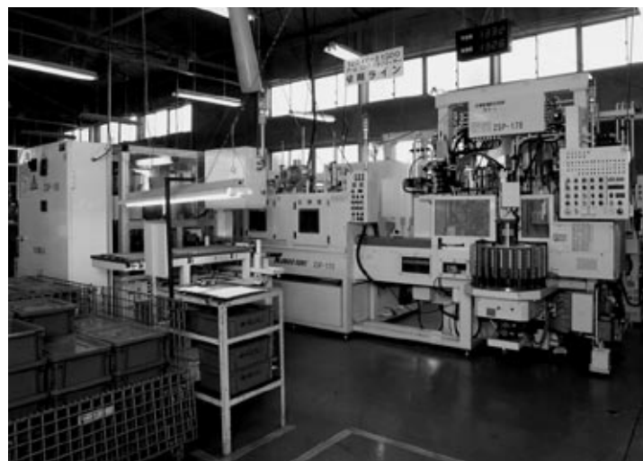
ロッカーアーム全自動ライン（機械加工、洗浄、検査、組立）
